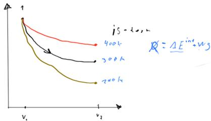
För en isoterm gäller  $PV = \text{konst}$ . För en adiabat gäller  $PV^{\left(\frac{C_p}{C_v}\right)} = \text{konst} = PV^\gamma$
